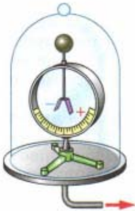
Şəkil-14. Nasosla havası sorulmuş mühitdə yüklənmiş elektroskop
