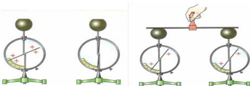
Şəkil 9. Elektrometrlə elektrik yüklərinin bölünməsinin nümayişi
