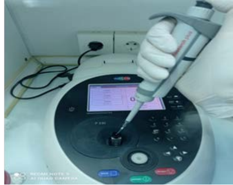
Şəkil 6, 7. Kür suyundan təcrid olunmuş yabarı Bacillus polymyxa ştamminından əldə olunmuş bakteriosinin konsentrasiyasının və təmizliyinin spektrofotometrə ölçülməsi.
